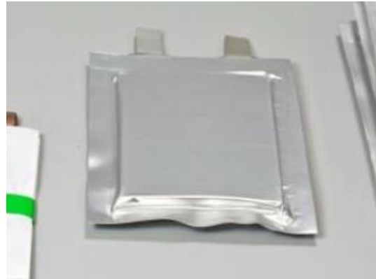
Prototypzelle mit Lithium@Kupferdrahtgewebe-Anode, Quelle: Fraunhofer IWS, Dresden
