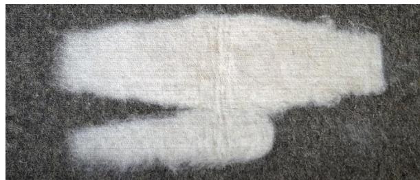
Topologisch optimierte Naturfaser-Halbzeugvariante, Quelle: optiformTEX
