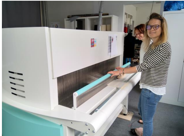
Mit dem TC2 elektronischen Jacquardwebstuhl sollen Designer, Studenten und Industriepartner Prototypen im zentralen Lab erarbeiten und diese gegebenenfalls an den Partnerinstituten weiterentwickeln können. FOTO: STFI
