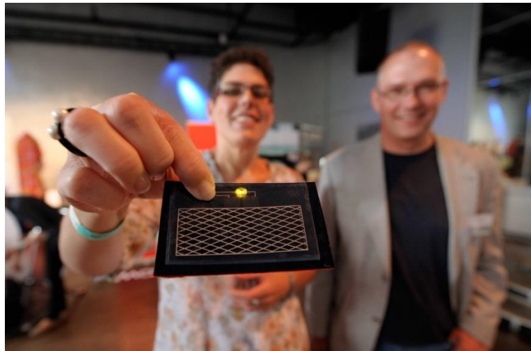
Die gedruckten, biegbaren Leiterbahnen und deren hohe Flexibilität auf dünnen Textilien waren eine positive Überraschung für viele Besucher. FOTO: Wear It Berlin GmbH
