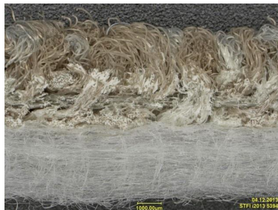
Querschnitt durch den Teppich-Verbund mit Referenz-Teppichrücken aus 100% PES-Nadelvliesstoff (links) im Vergleich zu vernadeltem MER-Meltblown-Vliesstoff als Rückenware (rechts)
