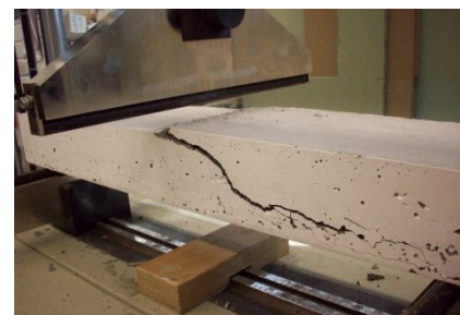
Drei-Punkt-Biegezugversuch mit Schubrisen in Höhe der textilen Bewehrung
