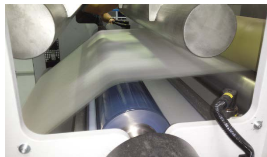
Integrierte Kiss-roll-Applikation im Spinnvlies-Technikum des STFI
