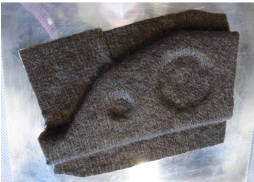
Abbildung 2: Teilstück einer C-Säule aus dem Kraftfahrzeugbereich der Fa. Alpha Sigma GmbH, links: Preform (Vliesstoff aus Basalt- und Carbonfasern) auf dem Werkzeug drapiert, rechts: vliesstoffbasierter Composite (nach der Imprägnierung mit biobasiertem Epoxidharz im Vakuuminfusionsverfahren).
