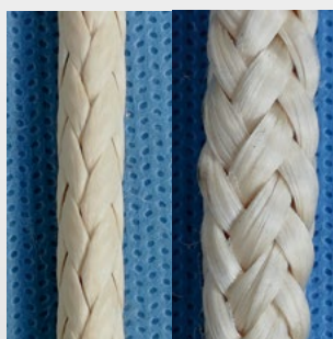
Abbildung 4: Probe VECTRAN™, neu (links), belastet (rechts)
