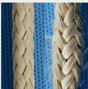
Abbildung 3: Probe TECHNORA®, neu (links), belastet (rechts)
