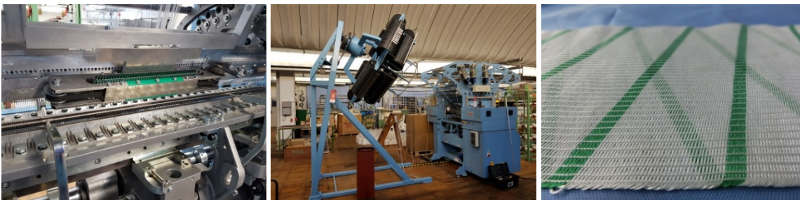
Abb.: Eingebaute Diagonalschussvorrichtung (links), Versuchsstand mit angebauter Rotierender Zuführeinrichtung (Mitte), Musterstruktur mit diagonal verlaufenden Schussfäden (rechts)
