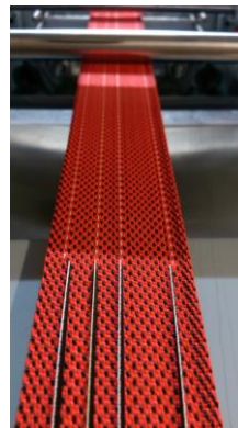
Integration elektrisch leitfähiger Sensoren für die Messfunktion in Bandgewebe
