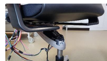
Abbildung 3: Demonstratorstuhl mit modifizierter Höheneinstellung
