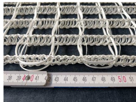
Abbildung 3: Textile Bewehrung – Abstandsgewirke
