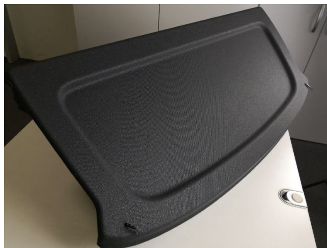
Abbildung 1: Schwarzer, geprägter Nadelvliesstoff in Punkt Optik als Dekormaterial in einer Hutablage des VW Golf A8 hergestellt von der Ideal Automotive Oelsnitz GmbH.
